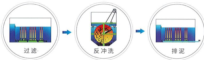
过滤——原水首先进入滤池，依靠重力作用通过滤布，后由盘片侧上方的出水管出水。
